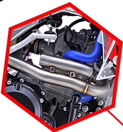
Выхлопная труба из нержавеющей стали с резонатором PowerBomb
